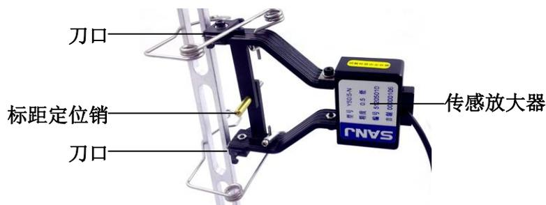
图 2-2 引伸计结构图
