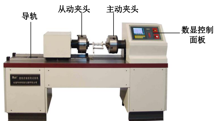
图 2-13 扭转试验机主机结构图
