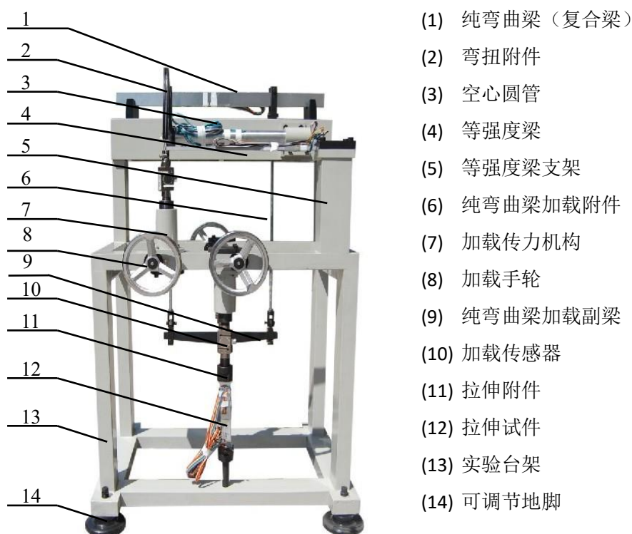
图 2-20 材料力学多功能实验台结构示意图
